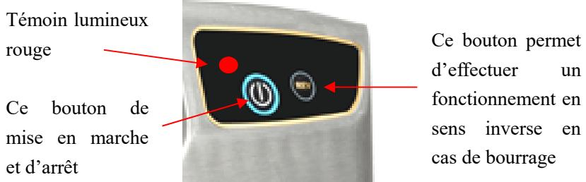
**Bourrage d'aliments :** Appuyer sur le bouton REV afin de faire tourner la vis sans fin en sens inverse du fonctionnement normal. Ce bouton fonctionne uniquement lorsque l'on maintient le doigt appuyer dessus. Lors du fonctionnement, le témoin lumineux rouge s'éclaire
