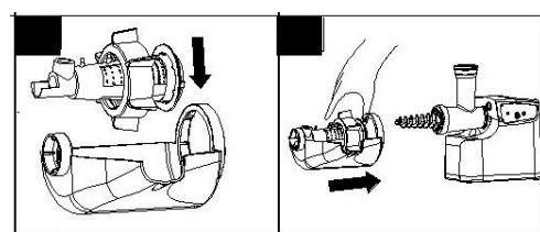
L'ensemble ainsi monté peut être positionné dans le plateau récolte jus "I" puis sur le corps du kit hachoir **N°14**
