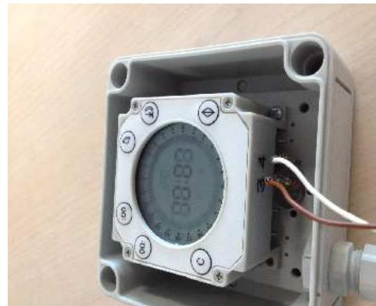
**4. Essai de fonctionnement.** Obscurcir totalement la sonde crépusculaire ou fermer avec la minuterie, ou encore shunter les contacts 3 et 4 avec le pont fourni de sorte que la trappe s'abaisse jusqu'en bas. Au bout de 10 s env. la trappe s'ouvre de nouveau. Pendant et après la fermeture, ne rien toucher dans le portier! **Après la mise en place ou une modification, procéder impérativement à un essai !**
