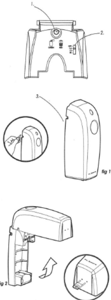
*Idéalement, le diffuseur doit être positionné à 2m du sol.*
