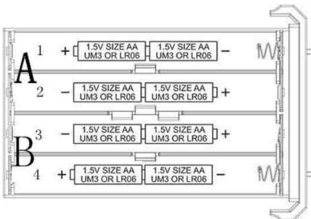
Le voltage du piège photographique est 12V. Pour fonctionner, l'appareil requiert 8 piles AA. Après avoir ouvert le couvercle du piège, assurez-vous que le sélecteur est en position OFF puis appuyez sur le bouton pour éjecter le compartiment à piles. Installez des piles neuves dans le compartiment en prenant soin de bien respecter les polarités indiquées. Puis replacez le compartiment à piles.
