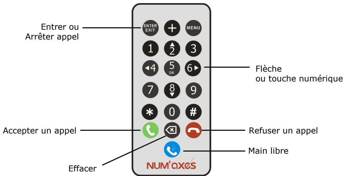
La télécommande sert à programmer l'appareil et pour la fonction téléphone. Elle fonctionne par infrarouge jusqu'à quelques mètres face à l'appareil. Pointez la télécommande vers l'avant de la caméra pour qu'elle fonctionne.
