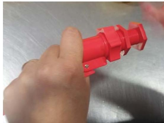
Dévissez et remuez l'écrou en plastique plus à l'extérieur du bras du flotteur.
