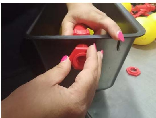
Insérez l'écrou en plastique sur le filet et vissez-le pour bloquer le flotteur.
