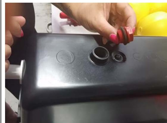
Insérez le joint d'étanchéité sur le filet du bouchon rouge.
